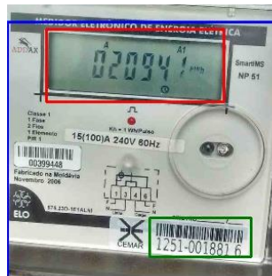
Figura 5. Segmentação semântica do medidor e componentes em imagens utilizando o método proposto.
