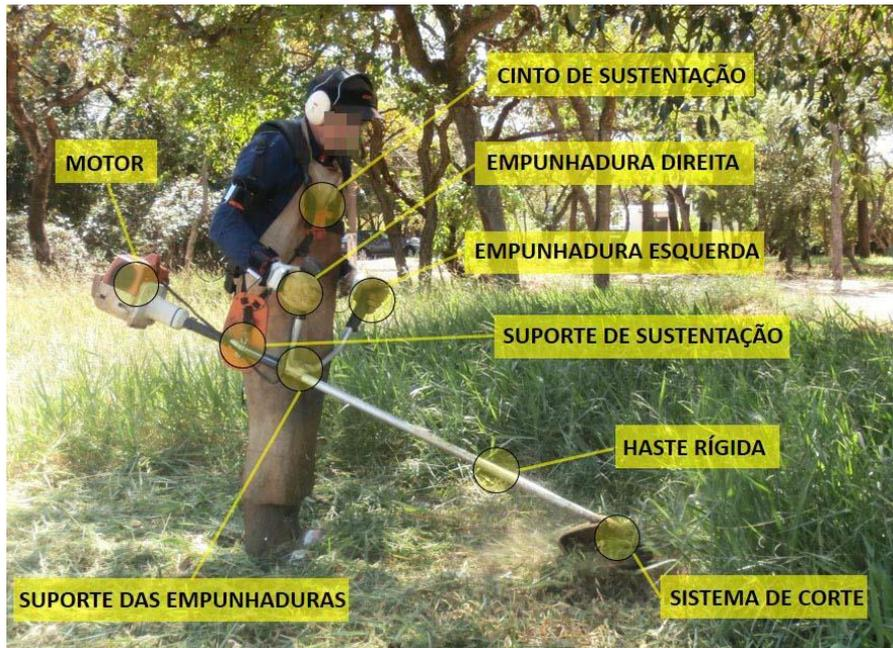
Figura 1 - Operador, Roçadeira Lateral Motorizada e seus componentes. Fonte: Elaborado pelo autor.
