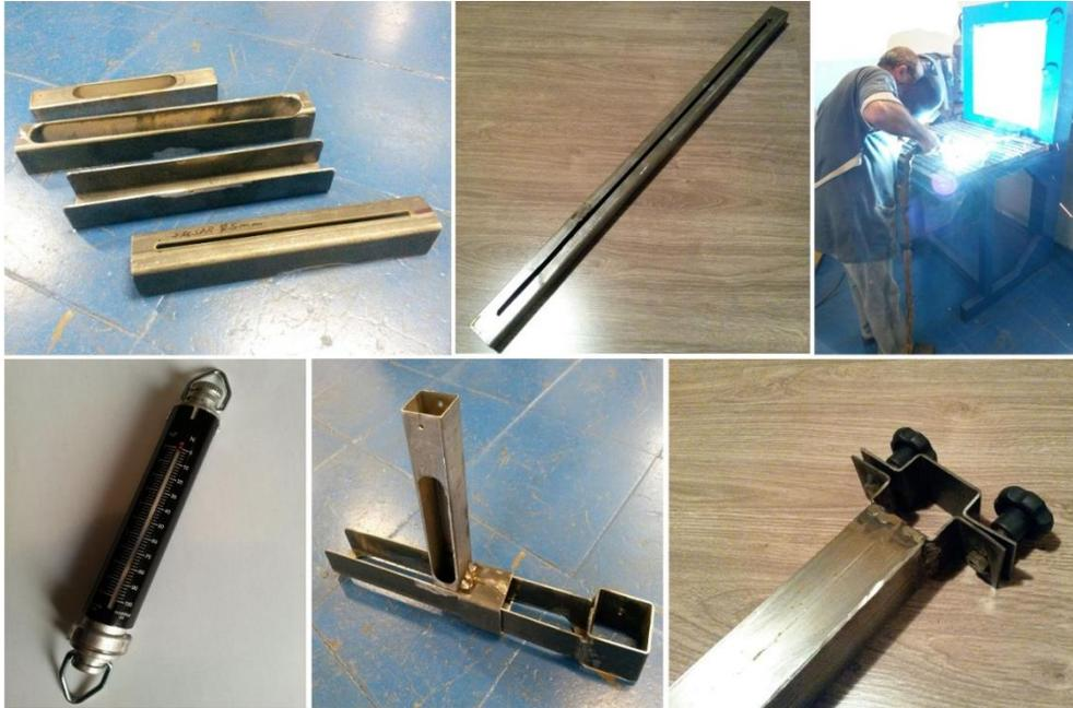
Figura 8 - Materiais utilizados e processo de soldagem do dispositivo. Fonte: Elaborado pelo autor.
