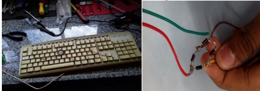
Fig. 2 – Pastilhas com fios soldados e ponte retificadora.
