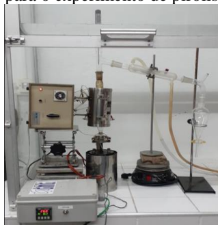
Figura 1. Reator utilizado para o experimento de pirólise térmica e termocatalítica
