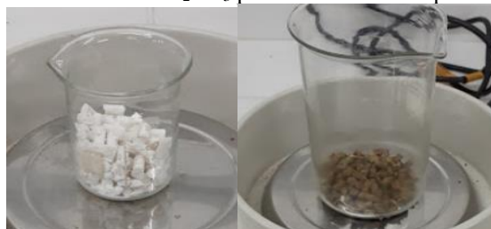
Figura 5: Catalisador de \text{Na}_2\text{CO}_3 peletizado antes e depois da pirólise.
