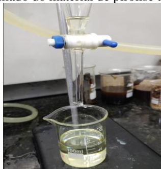
Figura 5. Destilado do material de pirólise termo catalítica
