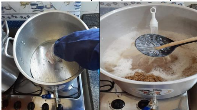
Figura 7: Meio filtrante utilizando panela de fundo falso acoplada na panela.
