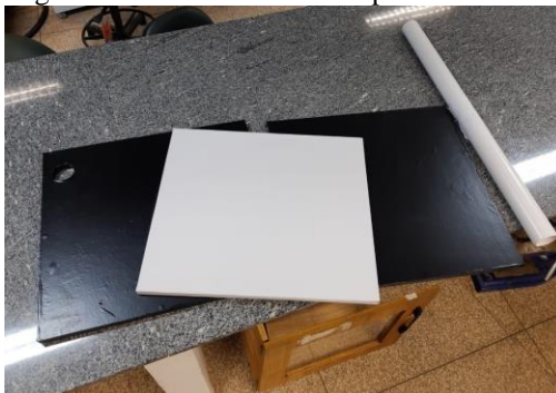
Figura 13 – Revestimento das placas em vinil.
