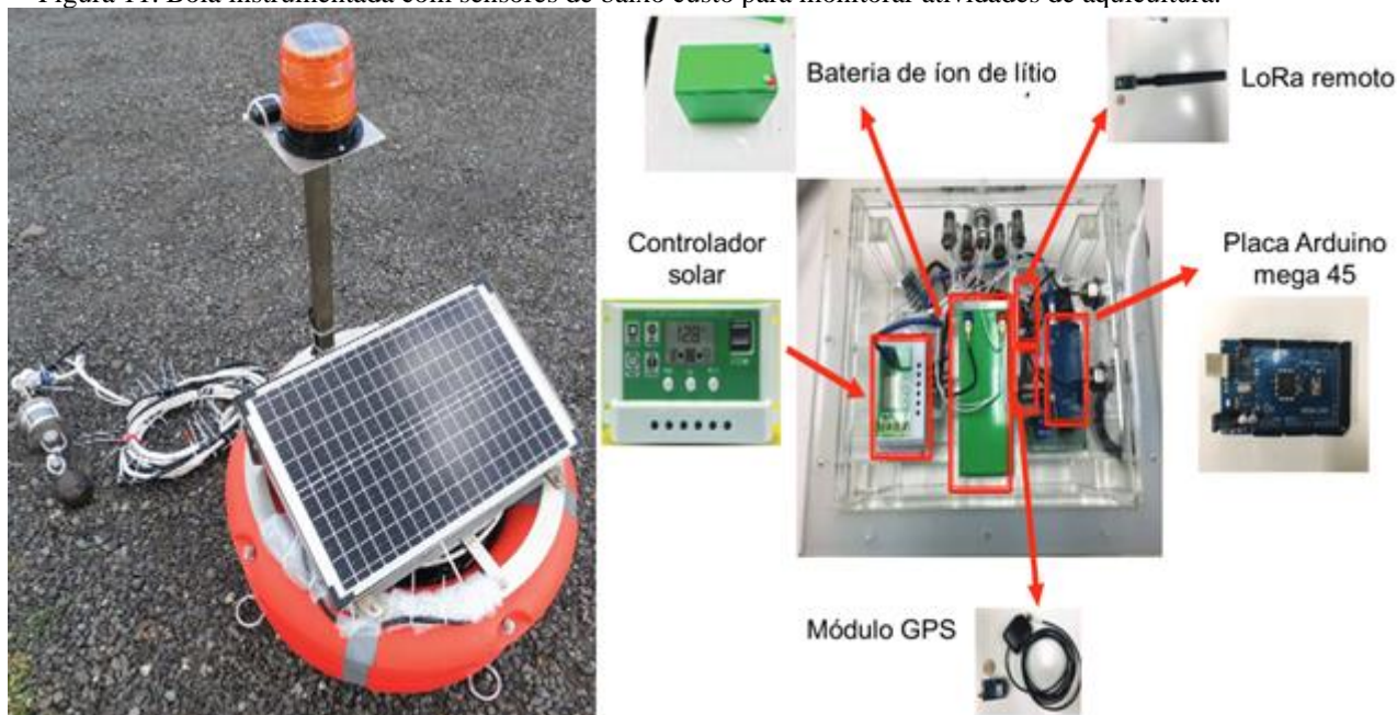
Figura 11. Boia instrumentada com sensores de baixo custo para monitorar atividades de aquicultura.
