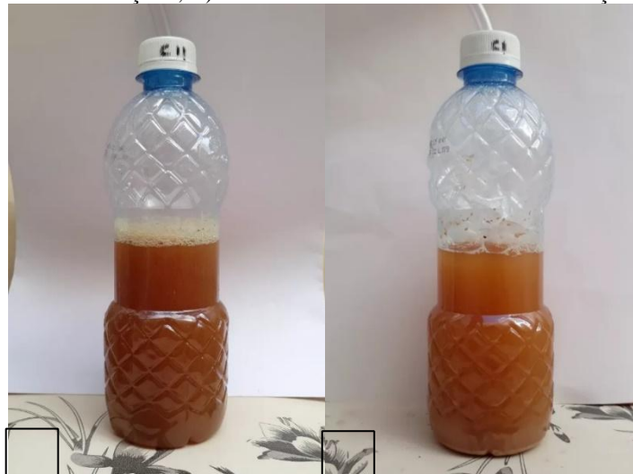
FIGURA 4 – EVOLUÇÃO DA CLARIFICAÇÃO DO HIDROMEL: A) APÓS 24H DE FERMENTAÇÃO; B) APÓS O TÉRMINO DA FERMENTAÇÃO.
