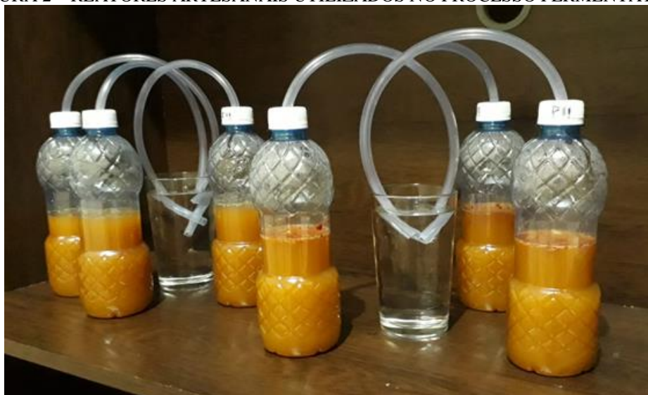
FIGURA 2 – REATORES ARTESANAIS UTILIZADOS NO PROCESSO FERMENTATIVO.
