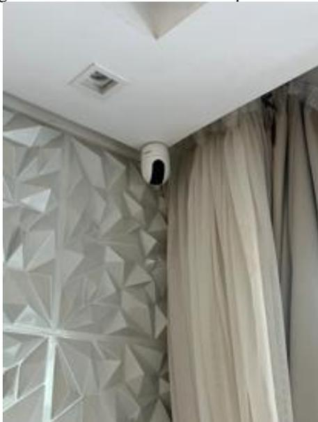
Figura 16 – Sensor instalado no quarto de casal
