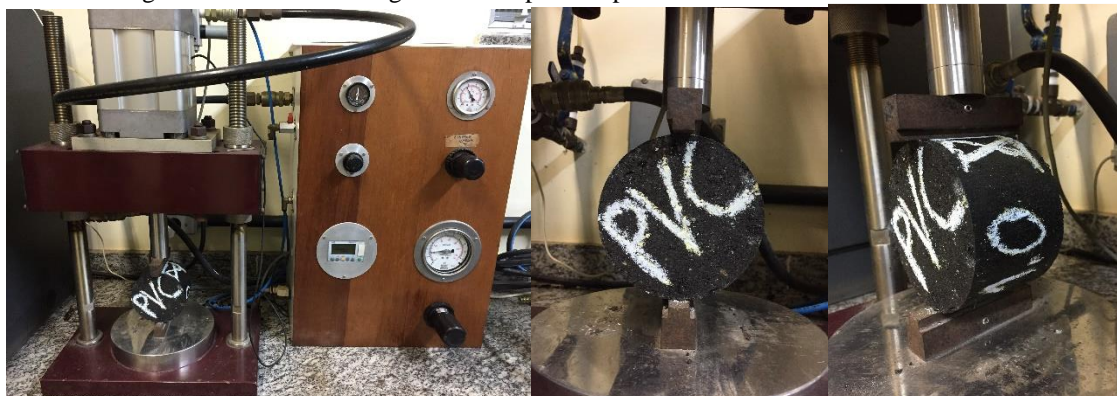
Figura 6 – Ensaio de fadiga realizado por compressão diametral à tensão controlada
