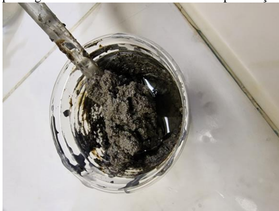
Figura 10. Aspecto granulado da tinta de acabamento após adição de 2% de OG
