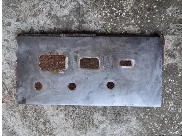
Figura 4. Corpo de prova com descontinuidades com óxido de ferro compactado;
