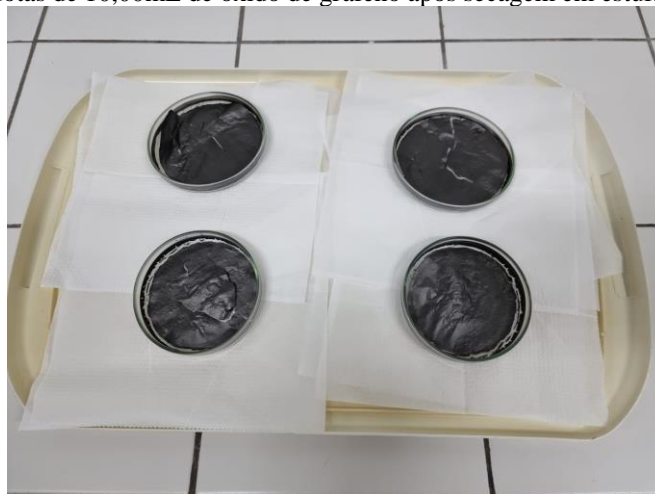
Figura 7. Alíquotas de 10,00mL de óxido de grafeno após secagem em estufa a 150°C por 3h
