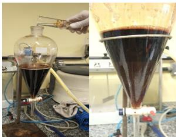
Figura 2: Extração ácido-base dos alcalóides da seiva da casca da Ucuúba ( Virola Surinamensis Warb.).
