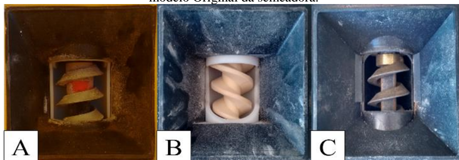
Figura 1. (A) FertiSystem modelo Auto-Lub AP NG, (B) BGAGROTEC modelo Nutri Evo e o (C) modelo Original da semeadora.
