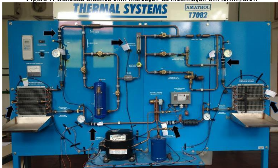
Figura 7. Bancada didática com indicação da localização dos termopares.
