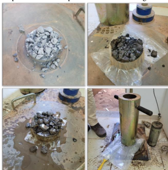
Figura 3: Da esquerda para direita e de cima para baixo: Treton no cenário seco, saturado, saturado e submerso e material plástico utilizado para conter a lâmina d'água no decorrer do ensaio.
