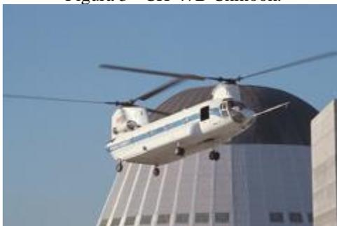
Cada rotor do Chinook possui três lâminas totalmente articuladas, sendo que os rotores são acionados em sentidos opostos. O controle longitudinal (ângulo de *pitch*) do CH-47 é obtido através das alavancas coletiva e coletiva diferencial. O controle lateral-direcional (*roll/yaw*) se dá através do cíclico e cíclico diferencial (Weber *et al.*, 1984).
