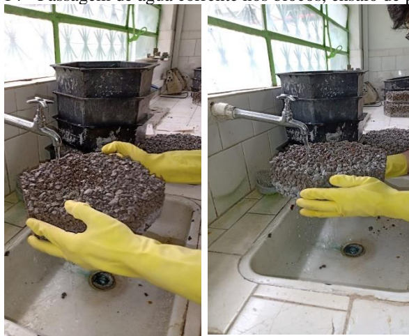
Imagens 13 e 14 - Passagem de água corrente nos blocos, ensaio de permeabilidade
