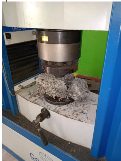
Imagem 12 - Rompimento do bloco, ensaio de resistência à compressão
