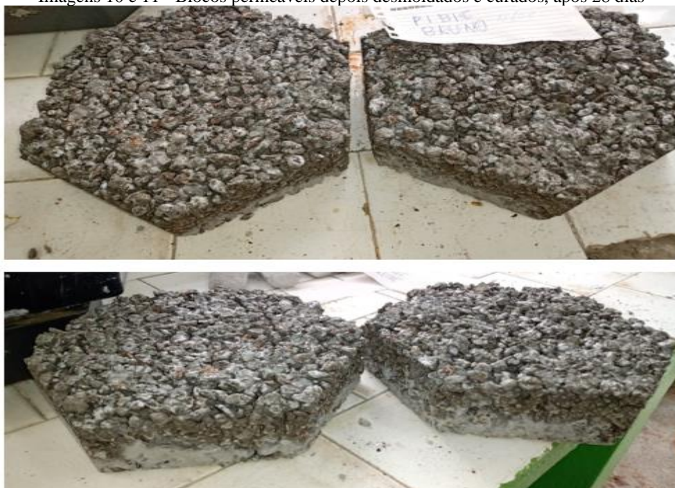
Imagens 10 e 11 - Blocos permeáveis depois desmoldados e curados, após 28 dias
