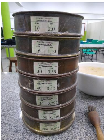
Imagem 8 - Peneiras utilizadas no peneiramento manual
