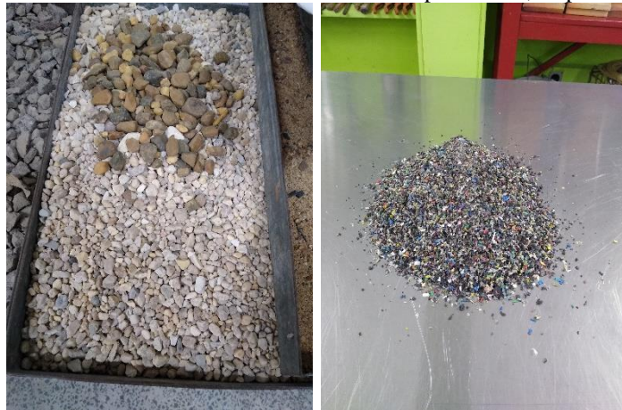
Imagens 6 e 7 - Materiais utilizados no concreto – brita 0 e polietileno, respectivamente
