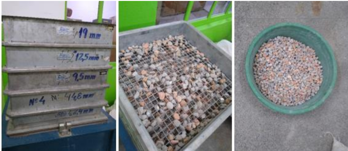
Imagens 3, 4 e 5 - RCD, depois de quebrado manualmente, passando por peneiramento e por último recolhido
