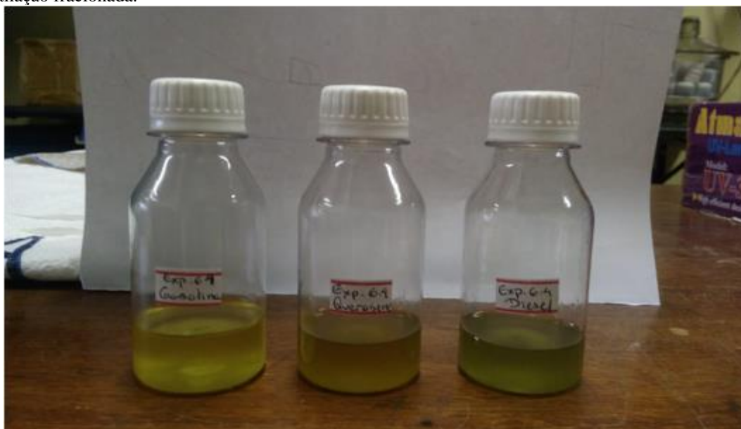
Figura 4: Frações de destilação [gasolina (amarelo), querosene e diesel (verde escuro)] obtidos por destilação fracionada.
