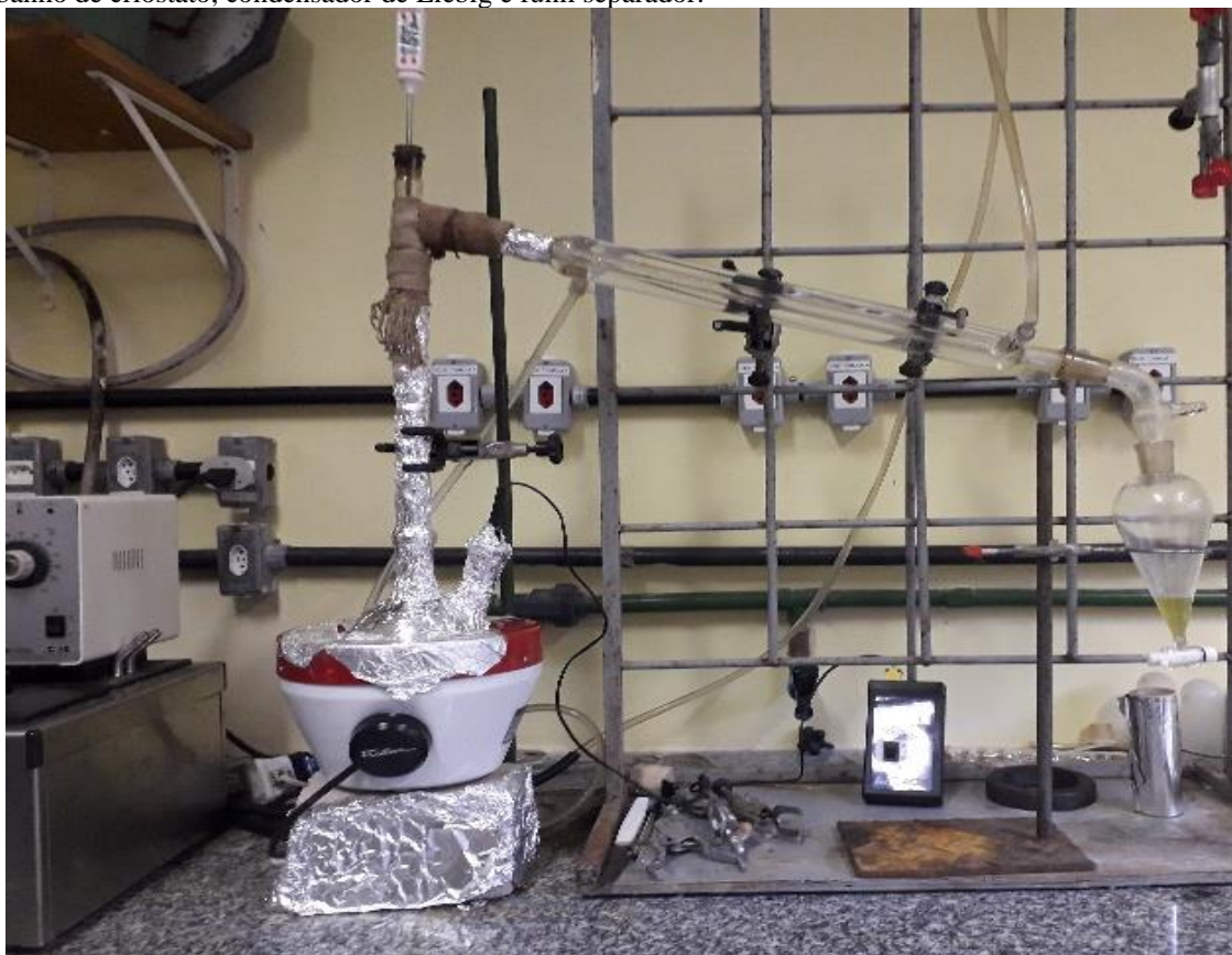
Figura 4: Coluna de destilação em vidro borossilicato Vigreux de 500 ml, manta de aquecimento elétrico, banho de criostato, condensador de Liebig e funil separador.
