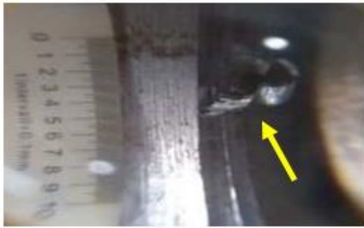
Figura 7: Ensaio e formação de cavaco em diversas condições utilizando o aço AISI 1045
