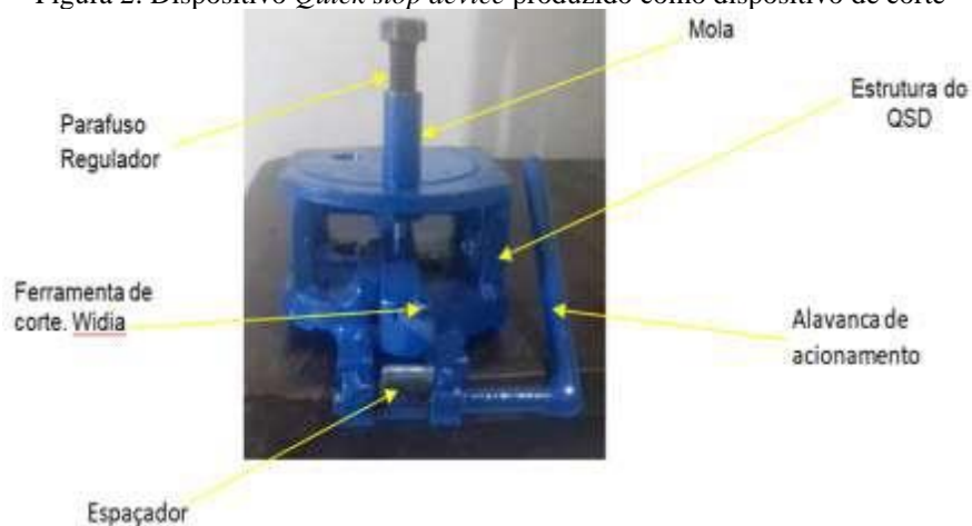
Figura 2: Dispositivo Quick stop device produzido como dispositivo de corte
