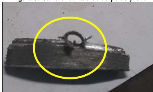
Figura 8: Cavaco retirado do corpo de prova
