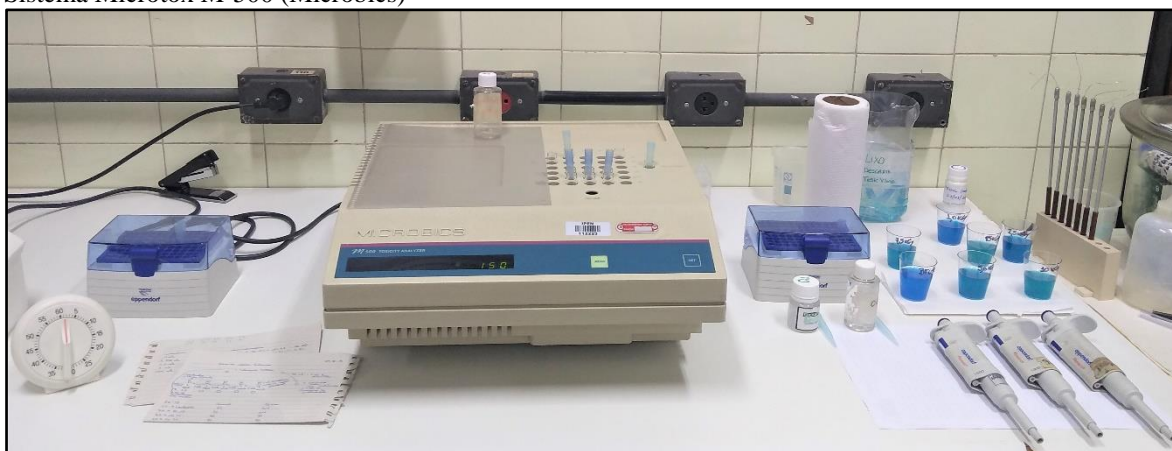
Figura 3: Ensaio de toxicidade para efeito agudo com Vibrio fischeri Sistema Microtox M-500 (Microbics)
