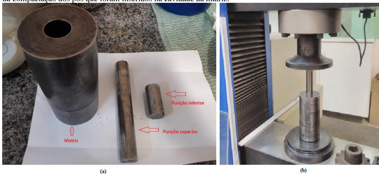
Figura 2. Sistema de compactação usado para a produção de briquetes: a) Matriz onde os pós de madeira foram inseridos em sua cavidade cilíndrica e punções inferior e superior usados para compactá-lo sob diferentes pressões; b) Máquina de Tração/Compressão usada para produzir os briquetes cilíndricos a partir da compactação dos pós que foram inseridos na cavidade da matriz.
