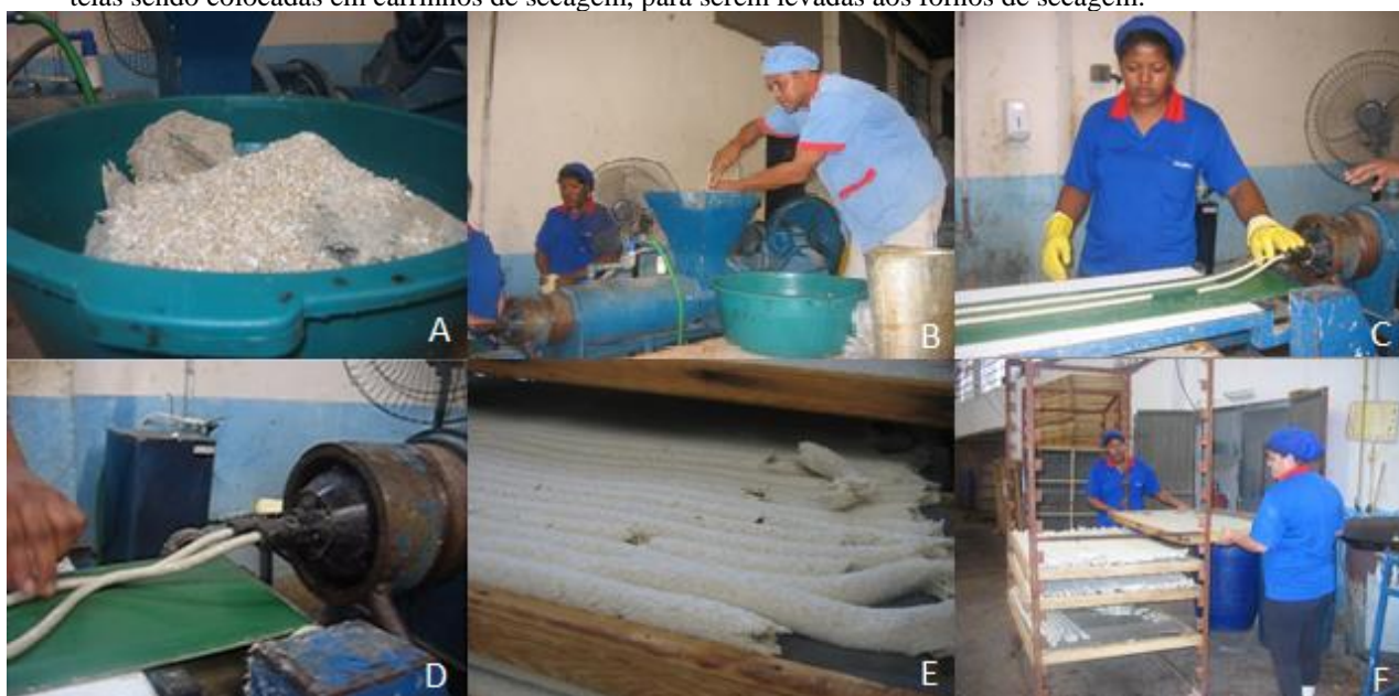
Figura 1 – Preparo dos petiscos tipo palitos. (A) a raspa de boi moída; (B) Introduzindo a mistura da raspa de boi com a inclusão de farinha de peixe na extrusora, (C e D) saída do “macarrão” que será desidratado para depois fazer os cortes dos petiscos tipo palitos. (E) em telas para secagem em fornos de secagem; (F) telas sendo colocadas em carrinhos de secagem, para serem levadas aos fornos de secagem.
