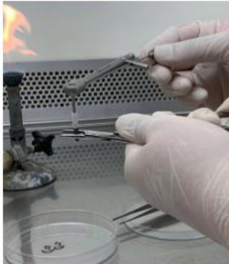
Figura 6 – Instalação do pilar protético pelo torque aplicado
