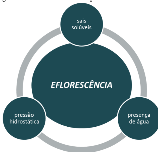
Figura 5 – Fatores necessários para a ocorrência da eflorescência
