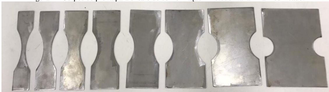
Figura 1 - Corpos de prova para ensaio de conformação - método Nakazima modificado.
