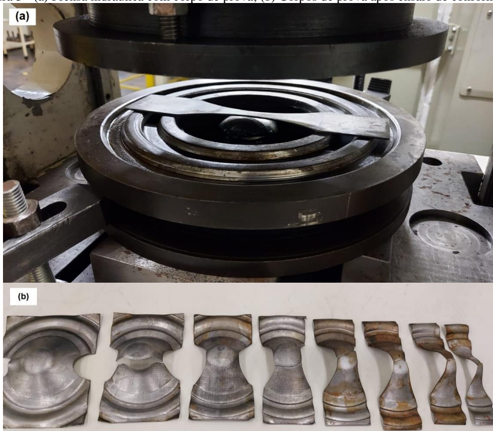
Figura 3 - (a) Prensa hidráulica com corpo de prova; (b) Corpos de prova após ensaio de conformação.
