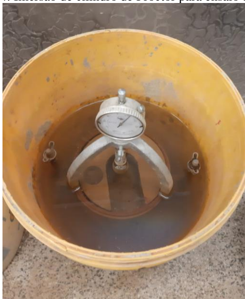
Figura 4: Imersão de cilindro de Proctor para ensaio de I.S.C.
