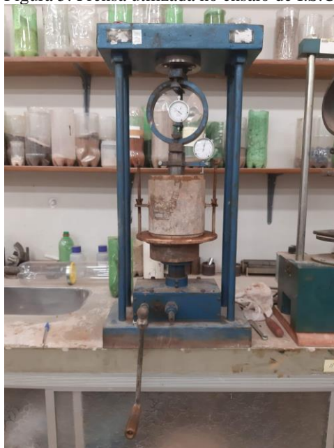
Figura 5: Prensa utilizada no ensaio de I.S.C.
