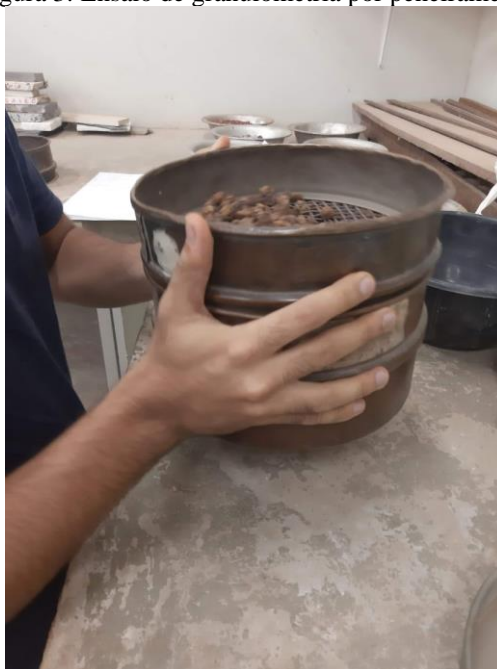
Figura 3: Ensaio de granulometria por peneiramento
