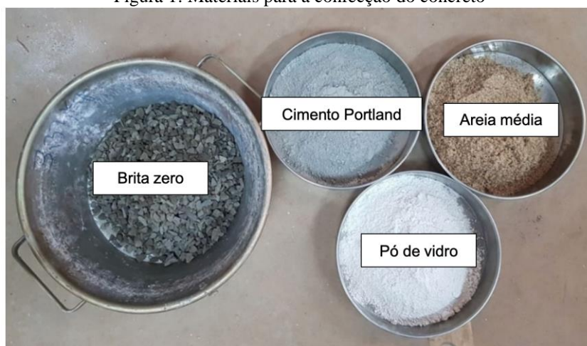
Figura 1: Materiais para a confecção do concreto
