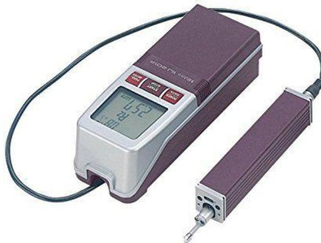
Existem variadas métricas relacionadas a rugosidade, sendo os parâmetros mais utilizados os Ra e Rz, sendo estes utilizados neste trabalho. O primeiro consiste na média aritmética dos valores absolutos de rugosidade auferida em determinado trecho, FIGURA
