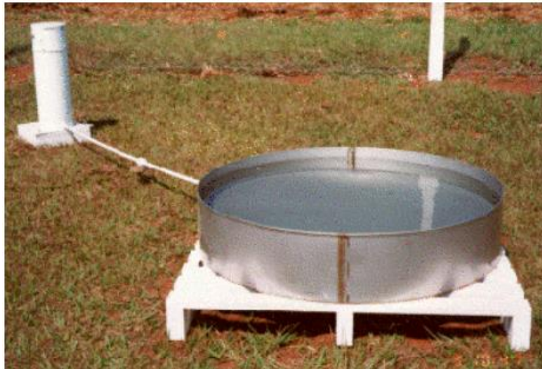
Figura 24 – Tanque classe “A”
