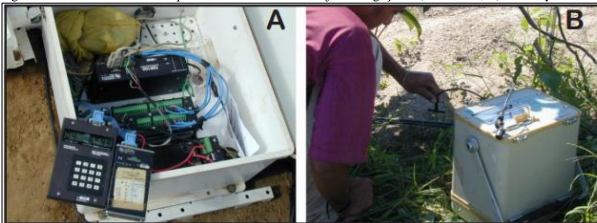
Figura 17 – Reflect metros do tipo TDR utilizados no manejo de irriga o: A) TDR 100; B) Trase System
