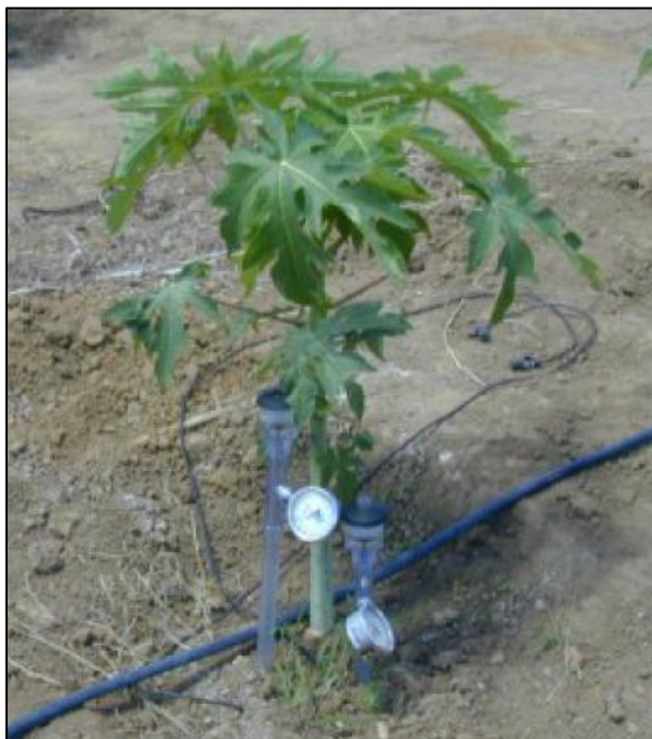
Figura 15 – Posicionamento de tensiômetros em cultura de mamoeiro irrigado
