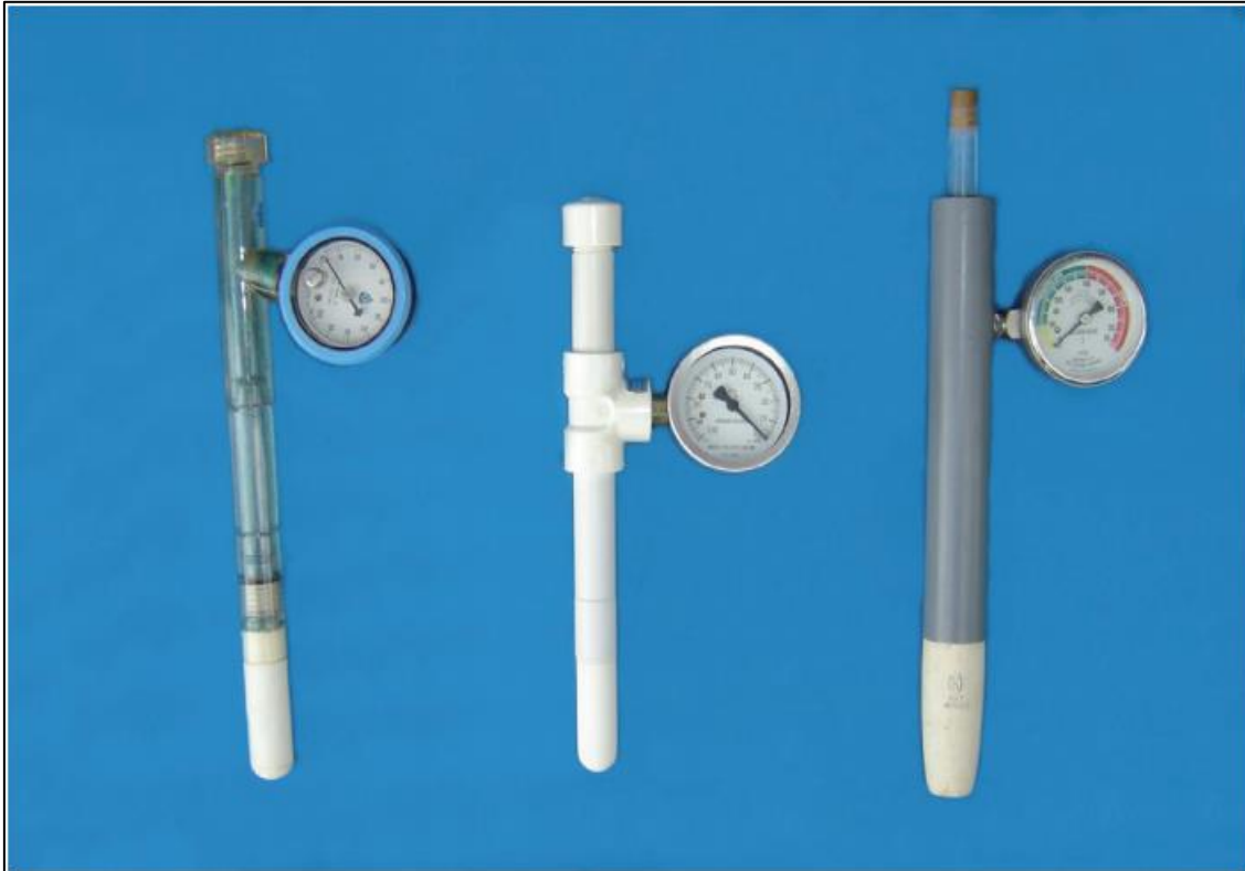
Figura 14 – Tensiômetro com vacuômetro metálico tipo Bourdon acoplado
