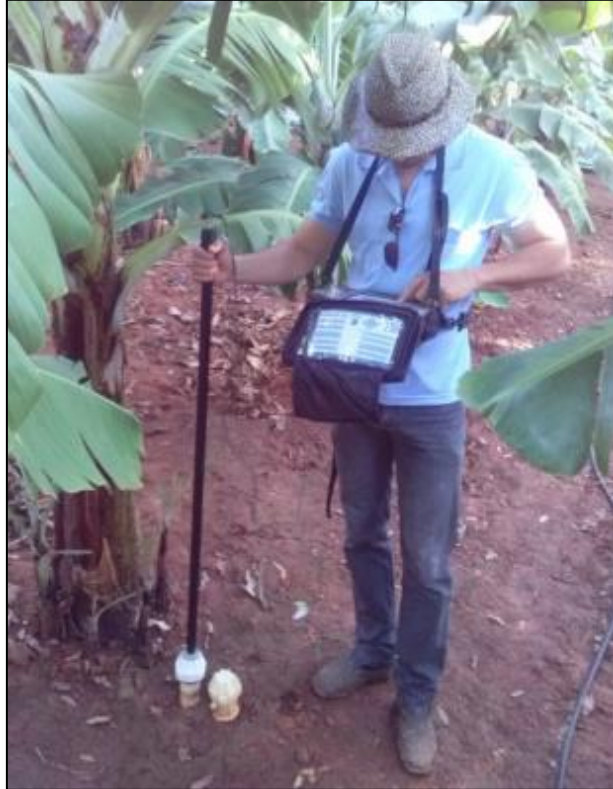
Figura 18 – Uso de reflectômetro do tipo FRD (sonda de capacitância) em campo
