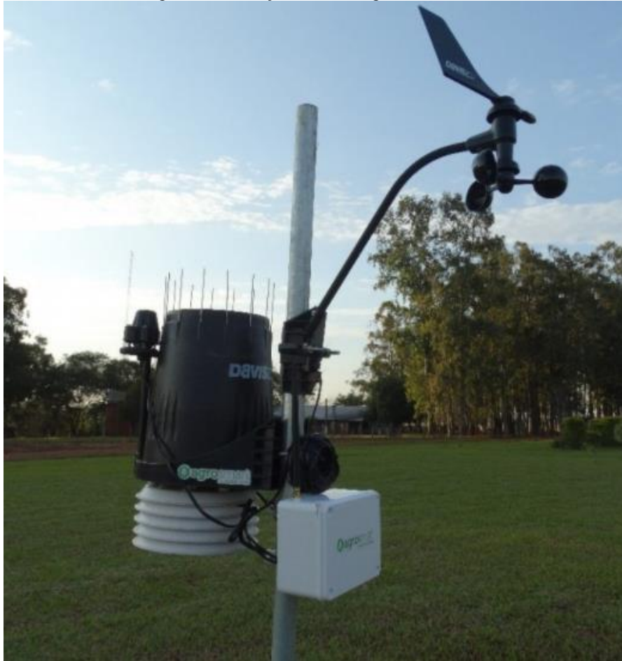
Figura 22 – Estação meteorológica automática
