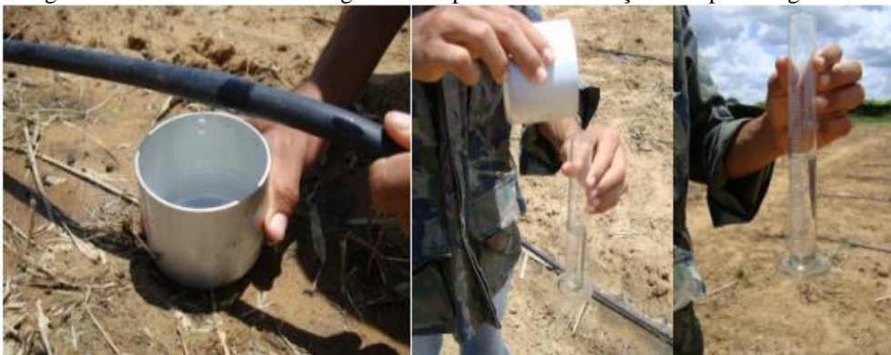
Figura 8 – Coleta da lâmina de água com copo coletor e medição com proveta graduada
