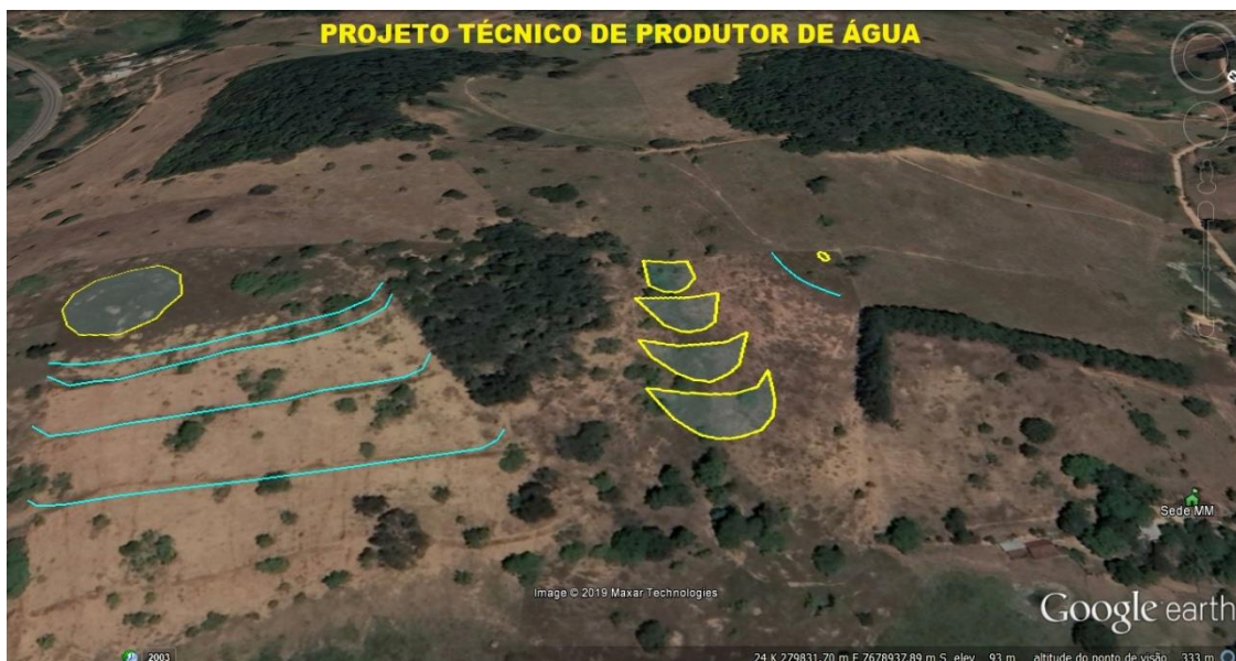
Figura 1- Marcação da área para a construção de barraginhas e os cochinhos, na zona rural do município de Atílio Vivácqua, Espírito Santo, Brasil.
