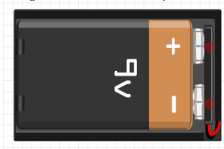
Imagen 3: Porta batería con pila de 9V.
