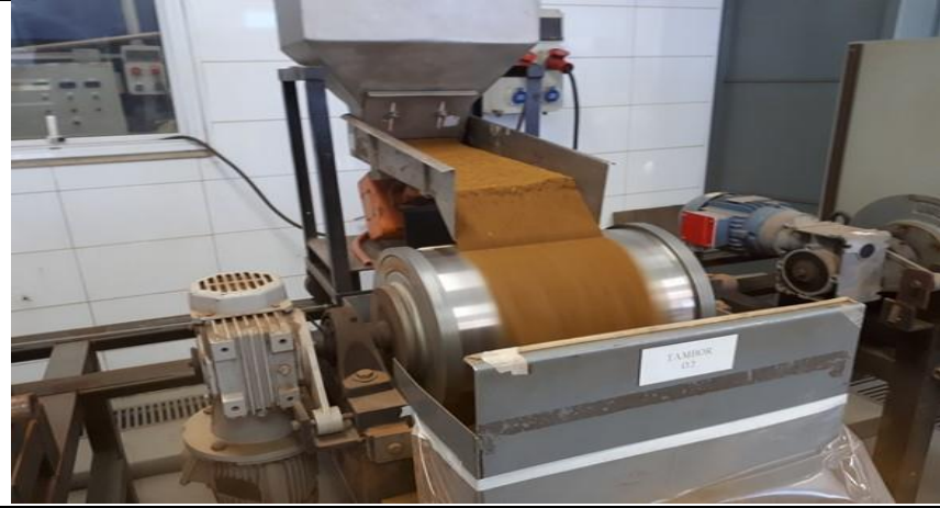
Figura 13- Teste de separação magnética na etapa de desbaste (rougher) com um campo de 2.500 gauss
