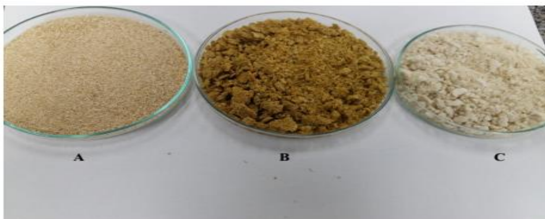
Figura 03- Comparação entre matéria prima (A), fibra mercerizada (B) e fibra branqueada (C).
