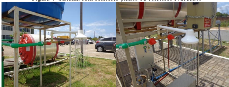
Figura 4- Sistema com coletores planos ou coletores evacuados
