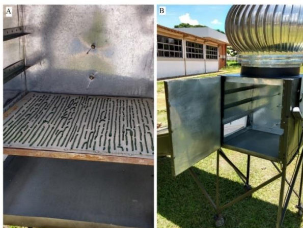
Figura 3: Detalhe da Câmara de Secagem: (A) Bandeja Colocada e (B) Vista Interna da Câmara.
