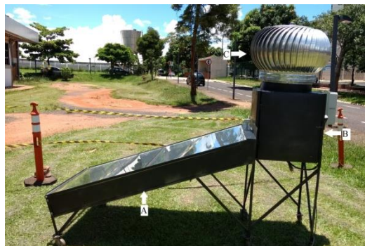
Figura 1: Vista Lateral do Secador Solar de Exposição Indireta: (A) Coletor Solar, (B) Câmara de Secagem e (C) Exaustor Eólico.
