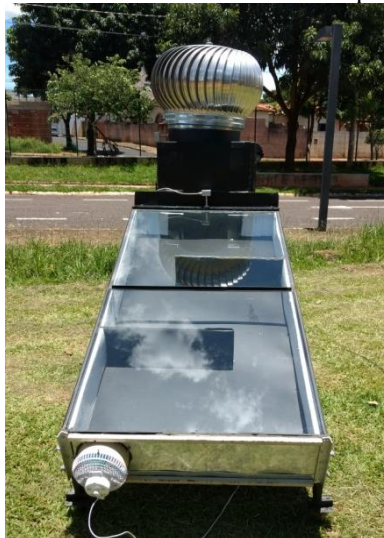
Figura 2: Vista Frontal do Coletor Solar com Destaque para as Divisórias.
