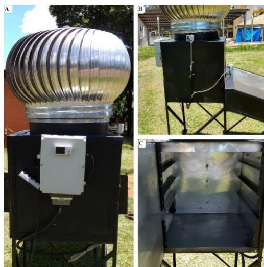
Figura 4: Detalhe da Instrumentação para Medida de Temperatura e Umidade: (A) FieldLogger, (B) RHT DM 150 mm e (C) PT100.
