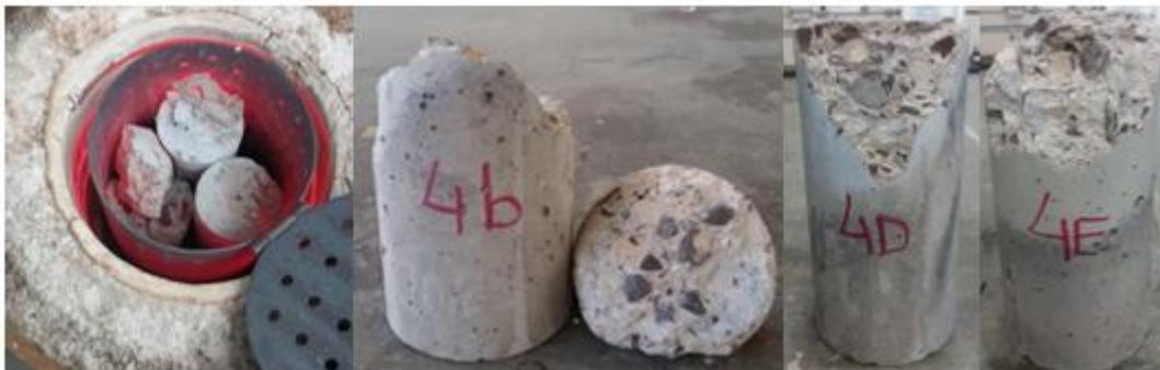
Por outro lado, os concretos com adição de 0,5 % de fibra de PET à temperatura de 800 °C, não apresentaram efeito *spalling*. Apenas se observou a formação de pequenas fissuras superficiais nos corpos de prova conforme Figura 8, fato que provavelmente está associado a formação de tensão interna, devido a expansão térmica dos agregados.
