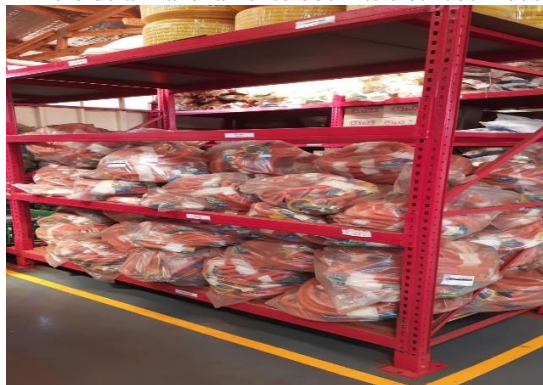
Imagem 2 - Meio de armazenamento dos kits elétricos industrializados.
