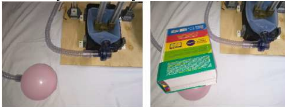
Figura 14 - Ensaio de carga de massa sobre balão de ensaio.
