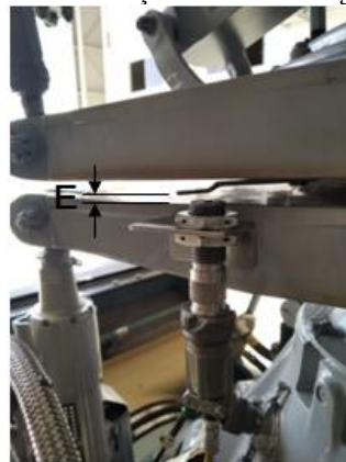
Figura 6 - Instalação do sensor magnético
