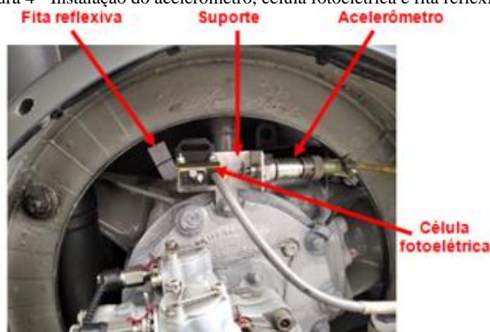
Figura 4 - Instalação do acelerômetro, célula fotoelétrica e fita reflexiva
