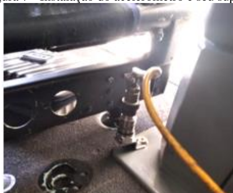
Figura 7 - Instalação do acelerômetro e seu suporte
