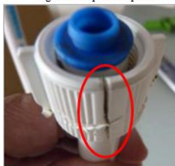
Figura 1: Ruptura de porca
