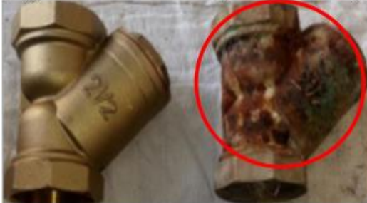
Figura 7: Conexões de bronze (a da direita corroída)
