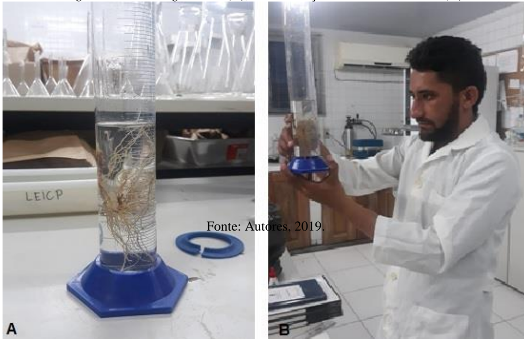
Figura 4 – Proveta graduada (A); Determinação do volume de raízes (B).
