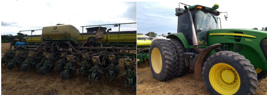
Figura 1. Semeadora 15 linhas John Deere modelo 2117 CCS, no lado esquerdo, e trator John Deere modelo 4210J, no lado direito.
