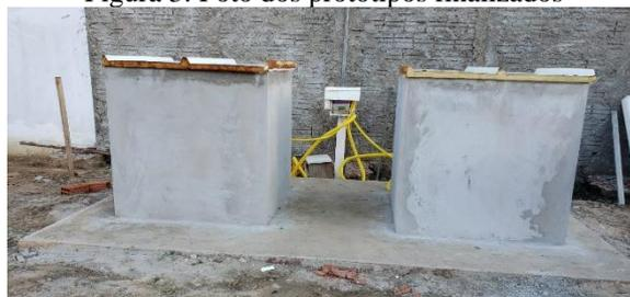
A metodologia se baseia em uma coleta das temperaturas internas de ambos os protótipos e do ambiente externo durante 15 dias com intervalos de 10 minutos entre cada coleta, totalizando assim 2160 ciclos. Essa coleta foi realizada através de sensores e de um sistema de Arduino posicionados no local conforme será apresentado na Figura 4 e após os dados coletados foi dado início à análise dos dados obtidos de diversas maneiras.
