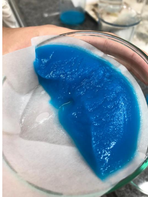
Figura 3. Hidróxido de Cobre (II) filtrado em repouso no papel de filtro
