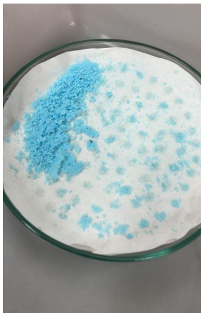
Figura 6. Sulfato de cobre penta-hidratado límpido formado após lavagem do mesmo com álcool absoluto (etanol).
