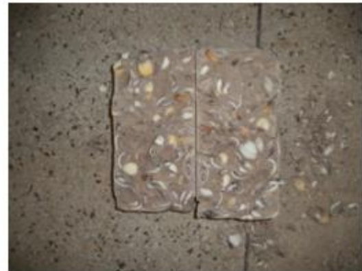
Figura 6 - Ruptura após aplicação de carga de compressão diametral: Corpo de prova da família 1; (b) Corpo de prova da família 2.
