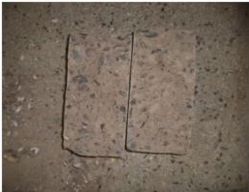
Figura 6 - Ruptura após aplicação de carga de compressão diametral: Corpo de prova da família 1; (b) Corpo de prova da família 2.
