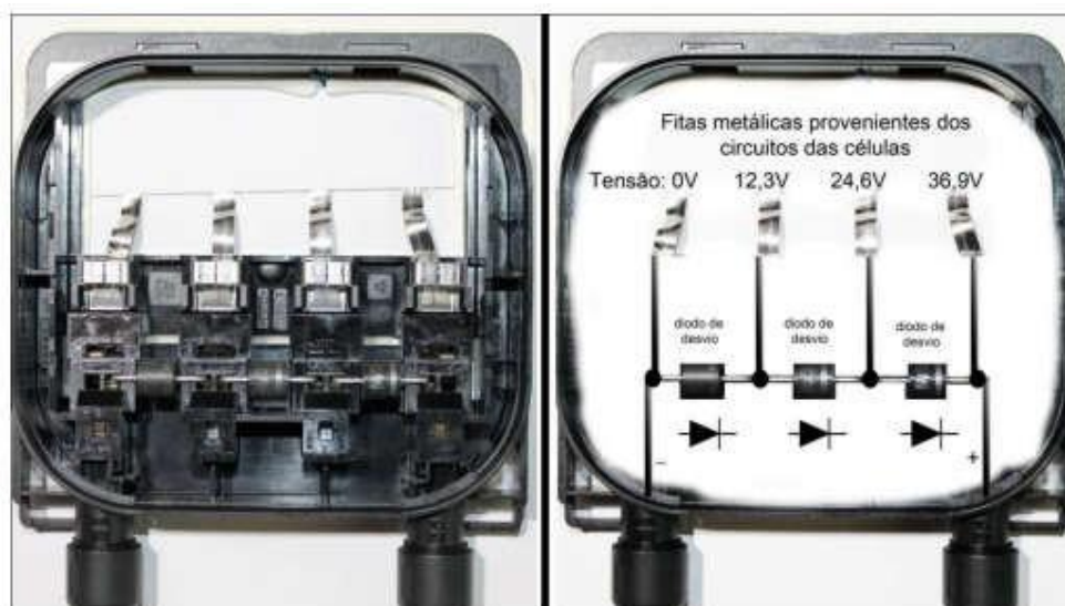
Figura 7 - Caixa de conexões e seu respectivo diagrama
