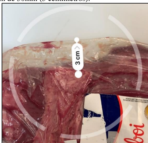
Figura 1: Altura (h) máxima encontrada do filme plástico não aderido nas peças de Acém; constatado desprendimento da embalagem de 30mm (3 centímetros).
