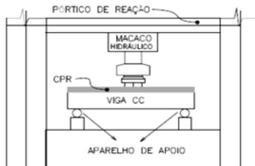
O reforço em UHPC foi realizado na região de compressão do concreto em três vigas e em outras três vigas esse reforço foi realizado na região de tração e em ambos os casos não foi colocada armadura adicional.
