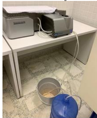
Figura 4 - Ensaios de análise granulométrica dos rejeitos de carvão mineral, cimento e cal (2).
