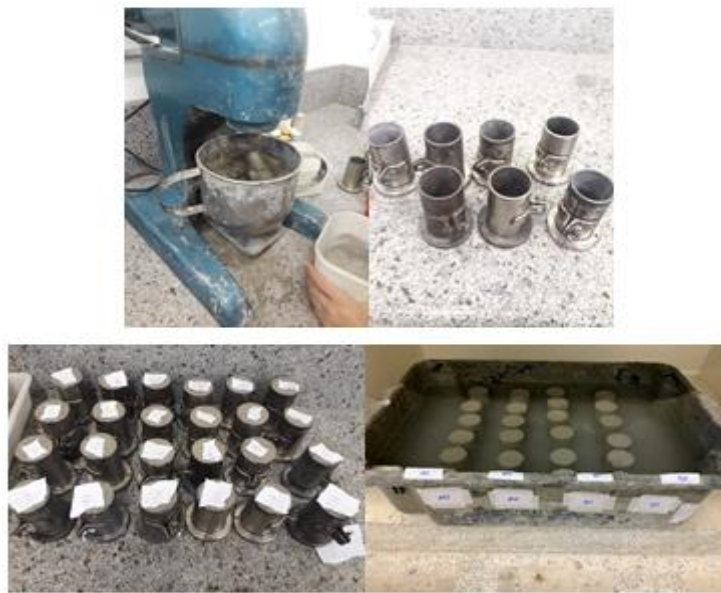
Figura 8 - Produção dos corpos de prova: Produção da argamassa (1), preparação dos moldes (2), confecção dos corpos de prova (3) e cura de 28 dias (4).
