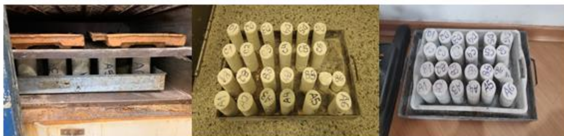
Figura 9 - Sequência do processo experimental: Retirada das amostras do processo de cura e colocados para secagem na estufa (1), amostras secas para início dos ensaios da NBR 9778 (2) e uma das fases previstas na NBR 9778, absorção de água por capilaridade (3).
