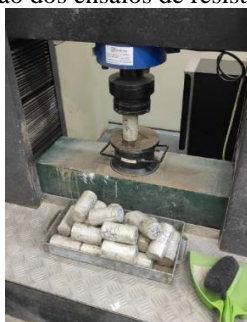
Figura 10 - Execução dos ensaios de resistência à compressão.
