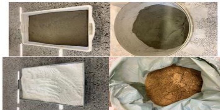
Figura 1 - Insumos utilizados: Rejeitos de carvão mineral (1), cimento (2), cal (3) e areia (4).
