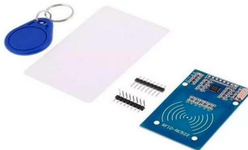
Figura 3 – Recursos RFID utilizados no protótipo [10].
